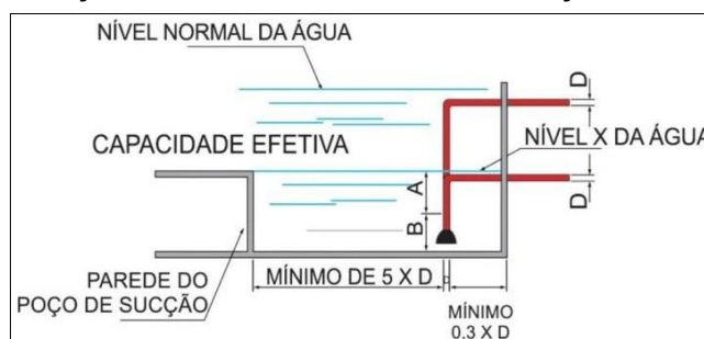
Figura B.2: Tomada superior de sucção para bomba principal
