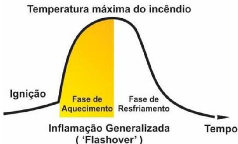
Figura 3 - Curva temperatura – tempo de um incêndio
