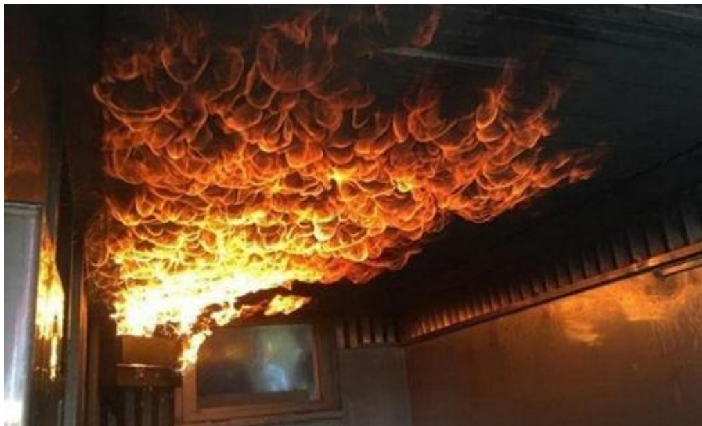
Figura 4 - Fase anterior ao “flash over” – grande desenvolvimento de fumaça e gases, acumulando-se no nível do teto (Fonte: rede mundial de computadores).
