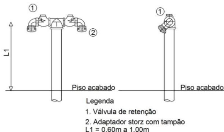
**Figura 09 – Tomada de recalque em caixa de alvenaria**
