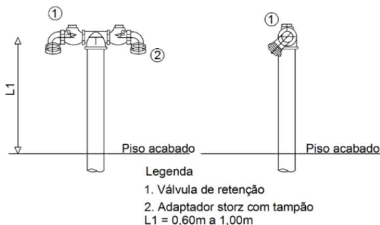
**Figura 09 – Tomada de recalque em caixa de alvenaria**
