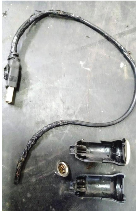
Figura 6: Sinais de degradação do cabo USB utilizado no ensaio.
