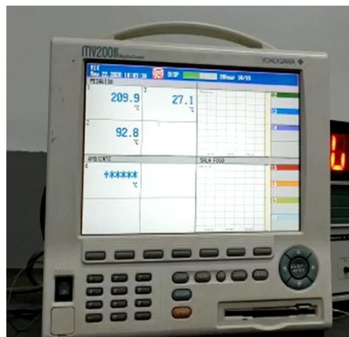
Figura 7: Temperatura elevada (209,9 °C) no cabo USB.
