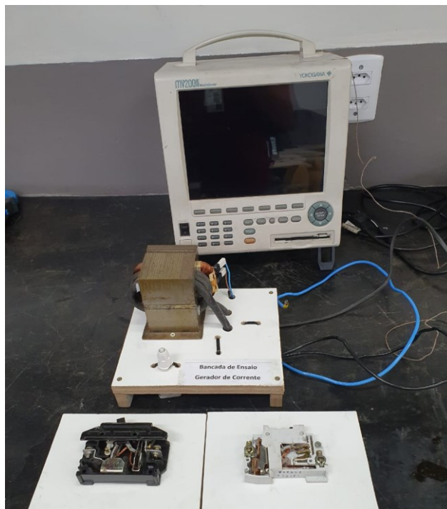
Figura 4 - Bancada de ensaio disjuntor termomagnético.
