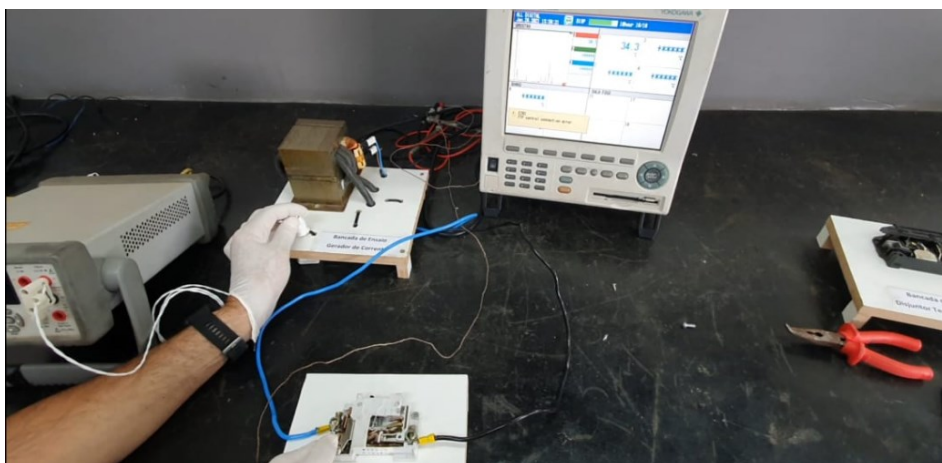
Figura 8 – Início do teste com disjuntor tipo DIN com defeito provocado.
