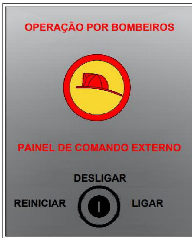
Figura 26: Exemplo de painel de comando externo (comutador externo)
